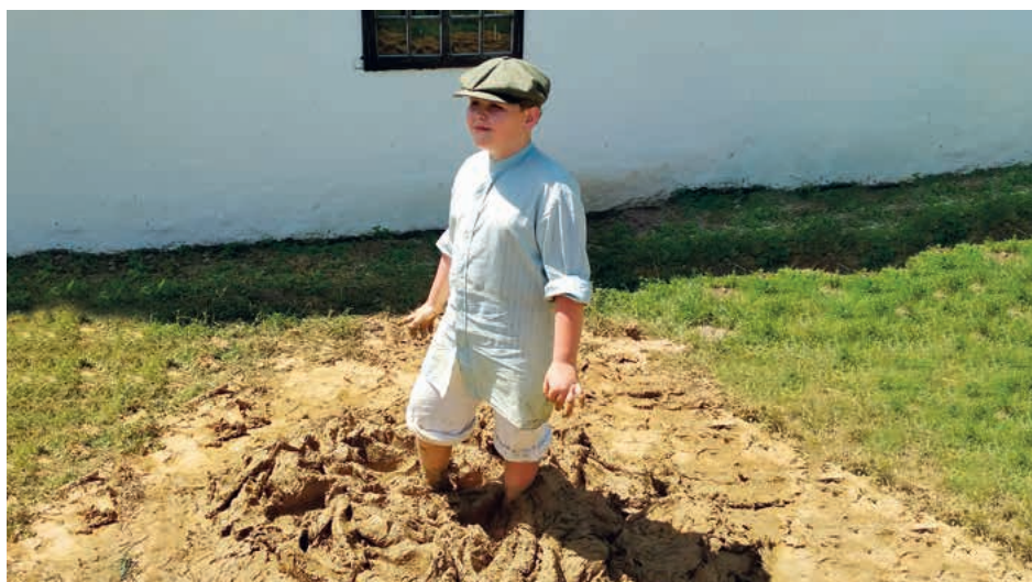
↑ Demonstrace postupu výroby nepálených cihel (Muzeum vesnice jihovýchodní Moravy Strážnice, foto P. Hudec)
